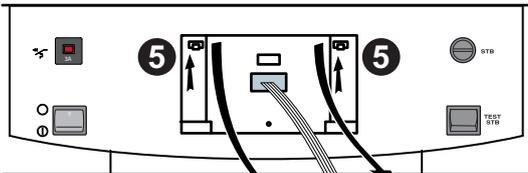
3. Die 2 Schrauben lösen.
