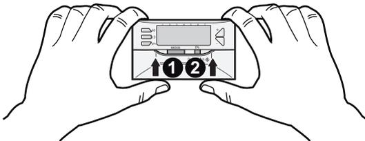
1. Das Steuermodul der Regelung aus seiner Basis nehmen, indem es leicht nach vorn gekippt wird.
