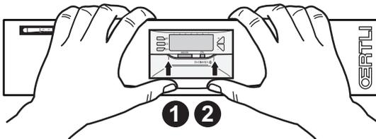
1. Das Steuermodul der Regelung aus seiner Basis nehmen, indem es leicht nach vorn gekippt wird.
