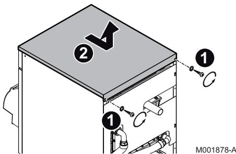
1. Die 2 Schrauben lösen.
